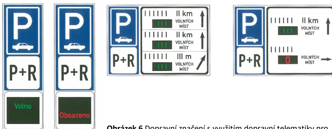
Obrázek 6 Dopravní značení s využitím dopravní telematiky pro označení a navádění k parkovišti P+R (16)
